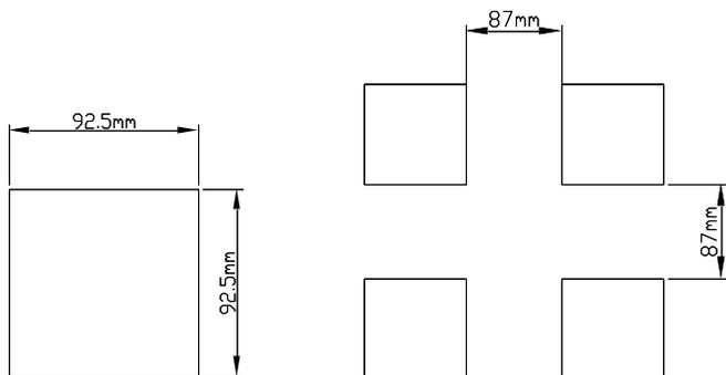
图 1 开孔尺寸及配电箱方孔间最小距离
