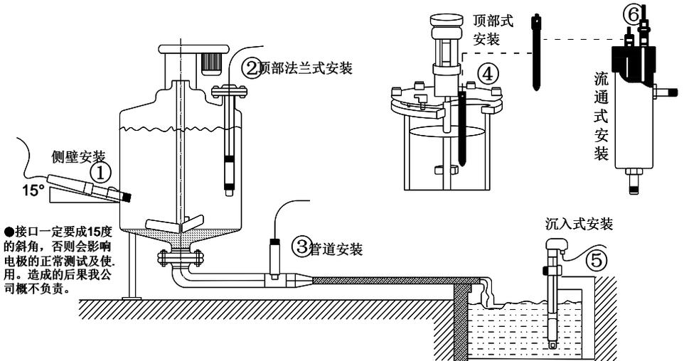
图4 常见安装方式示意图
